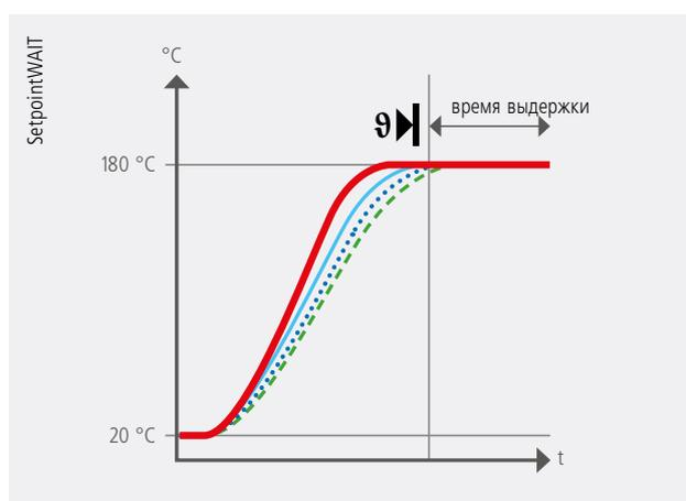
Когда SetpointWAIT функция активирована, время выдержки не начнется, пока температура в пределах очень узкого диапазона допуска не будет достигнута на всех точках измерения
